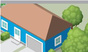
考虑采用五脊四坡式的屋顶设计。边角和突出部分较少的简洁设计所承受的风压较小。屋顶坡度越大，被冰雹和强风损坏的可能性就越小。
